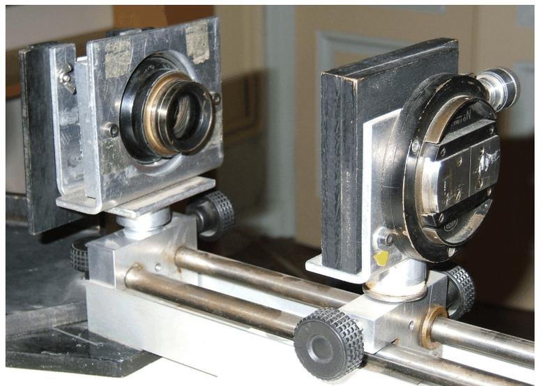
Théoriquement, la lentille devrait alors être réglée pour toutes les positions de la caméra quel que soit l'angle de visée, mais les déformations dues au réseau et les aberrations de sphéricité font que ce réglage ne sera plus valable pour une positions angulaire donnée de la caméra.
