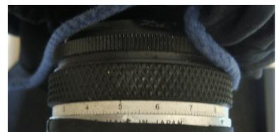
Le bon réglage sera trouvé par analyse d'images obtenues à **différentes positions de la bague de mise au point** d'objets situés à l'infini (plus de 100 mètres) :
