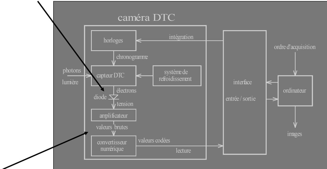
Le signal analogique qui en résulte (sous forme de tension électrique) est alors amplifié puis numérisé pour être traité par l'ordinateur.
