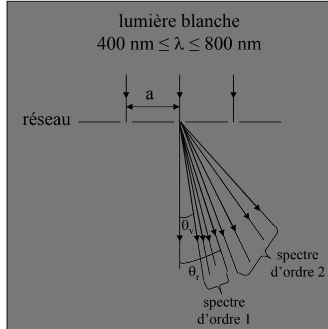
La résolution propre d'un réseau dépend du nombre total de traits éclairés ;
