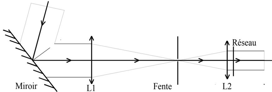
L'ouverture de faisceau lumineux avant la fente est  $\frac{d_1}{f_1} = \frac{5,5}{35} = 0,16$
