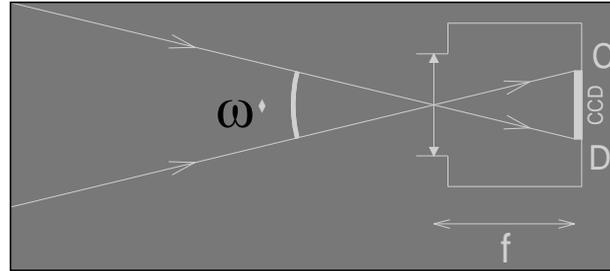
Ce champ dépend des *dimensions de la matrice* et de la *distance focale de l'objectif* utilisé.
