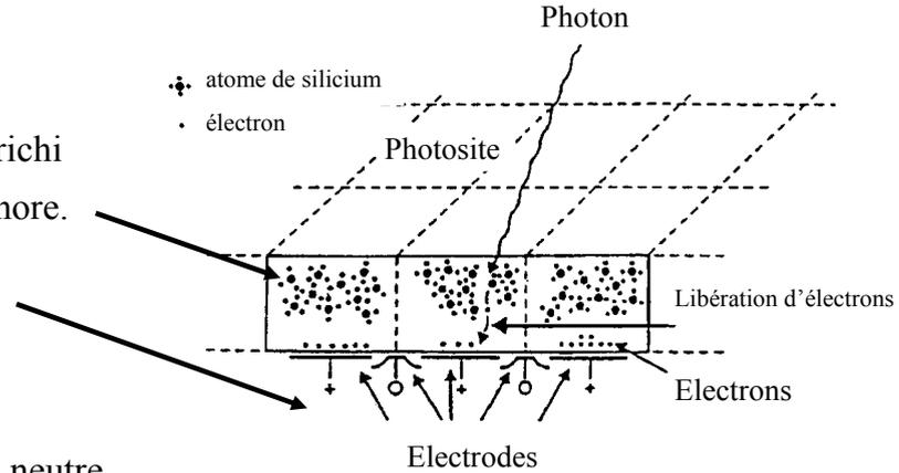
Lorsqu'un **photon** d'énergie suffisante pénètre dans le silicium dopé, il y a formation d'une paire (électron - trou).
