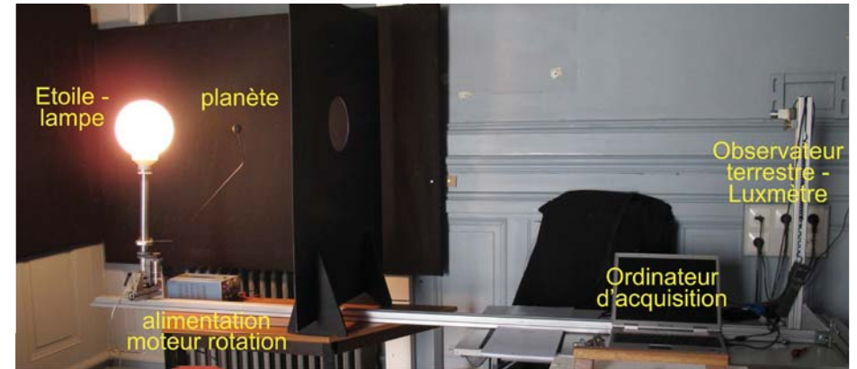
Montage de la méthode des transits
