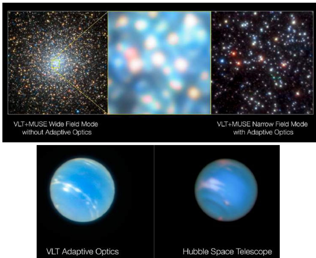
FIGURE 2.8 – Haut : comparaison de la résolution spatiale atteinte par, de gauche à droite, HST, MUSE sans optique adaptative et MUSE en mode NFM avec optique adaptative pour le même amas globulaire. Bas : comparaison de la résolution spatiale atteinte pour la planète Neptune avec, de gauche à droite, MUSE en mode NFM+AO et HST. Crédits : ESO/S. Kamann, ESO/P. Weilbacher, NASA.
