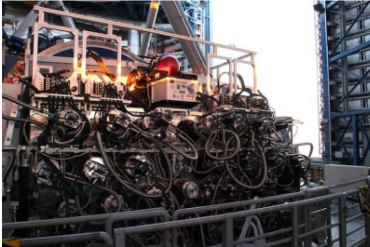
FIGURE 2.1 – Photographie de l'instrument MUSE sur le VLT. Crédits : ESO
